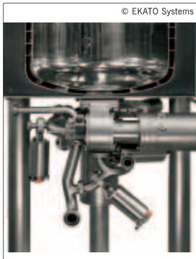
Der V-Jet trennt Förder- und Schervorgang bei der Herstellung von Emulsionen und Suspensionen.
