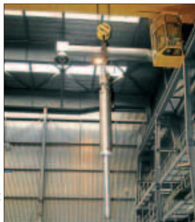
Zielscheibe für Protonen: Die 5 m lange Hülle des Flüssigmetall-Targets von MEGAPIE wird in der Spallationsneutronenquelle installiert.
