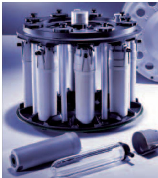
Abb. 1: Rotor 8S und 80-mL-Quarzgefäße
