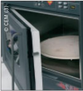
Die deutsche CEM bietet mit dem Mikrowellen-Trockner SAM 255 eine Alternative zum Vakuum-Trockenschrank. Er trocknet minutenschnell Polymer- und Formulierlösungen, Synthesansätze, Pharmazeutika, Milchpulver und Molkereiprodukte, Fleisch- und Wurstwaren ebenso wie Klärschlamm, Farben, Holz, Kohle oder etwa Farbkarten.
