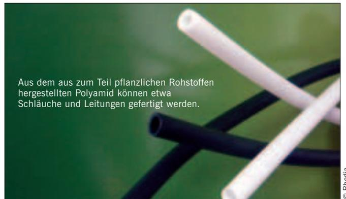
Aus dem aus zum Teil pflanzlichen Rohstoffen hergestellten Polyamid können etwa Schläuche und Leitungen gefertigt werden.
