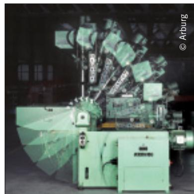
Seit nunmehr 50 Jahren produziert Arburg seine Spritzgießmaschinen des Typs „Allrounder“, die in mehreren Stellungen arbeiten können. Das Grundprinzip beschreibt das Unternehmen so: „Ein Drehpunkt mit Schneckengewindetrieb und gleiche Achsabstände machten den Einsatz von Schließ- und
