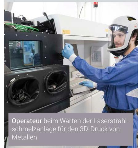
Operateur beim Warten der Laserstrahlschmelzanlage für den 3D-Druck von Metallen
