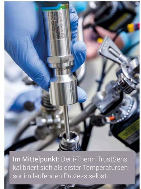
Im Mittelpunkt: Der i-Therm TrustSens kalibriert sich als erster Temperatursensor im laufenden Prozess selbst.
