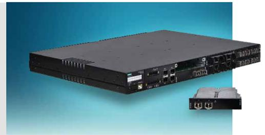
Siemens verringern sich damit die Betriebskosten, während gleichzeitig die gesamte Netzwerkleistung verbessert wird. Die Module arbeiten in einem Temperaturbereich von  $-40$  bis  $+85$  °C und widerstehen hohen elektromagnetischen und hochfrequenten Störungen. Sie eignen sich daher auch für betriebskritische Netzwerke in rauen Umgebungen. ■
