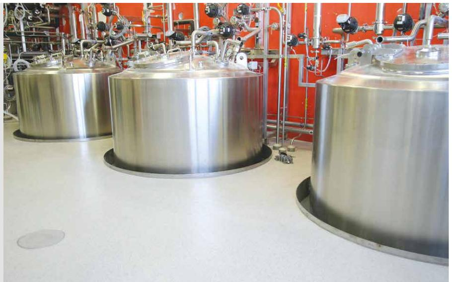
eher vermieden werden. Es empfiehlt sich, Bodensysteme jährlich warten zu lassen. Dabei werden Schäden an der Oberfläche und an den Fugen, Rissbildungen, undichte Stellen und Ausbrüche frühzeitig erkannt und mit geringem Aufwand umgehend repariert.
