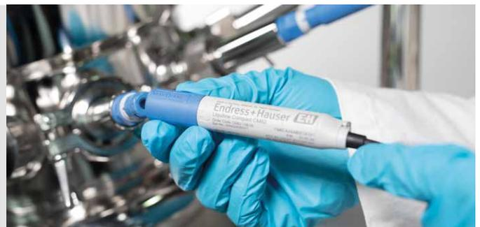
aus der Ferne warten. Über die App „Smart-Blue“ sind alle Messstellen innerhalb der Bluetooth-Reichweite des Tablets und Smartphones auf einen Blick einsehbar. Auch eine Konfiguration und Diagnose ist über die App möglich. ■
