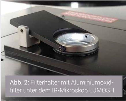
Abb. 2: Filterhalter mit Aluminiumoxid-filter unter dem IR-Mikroskop LUMOS II
