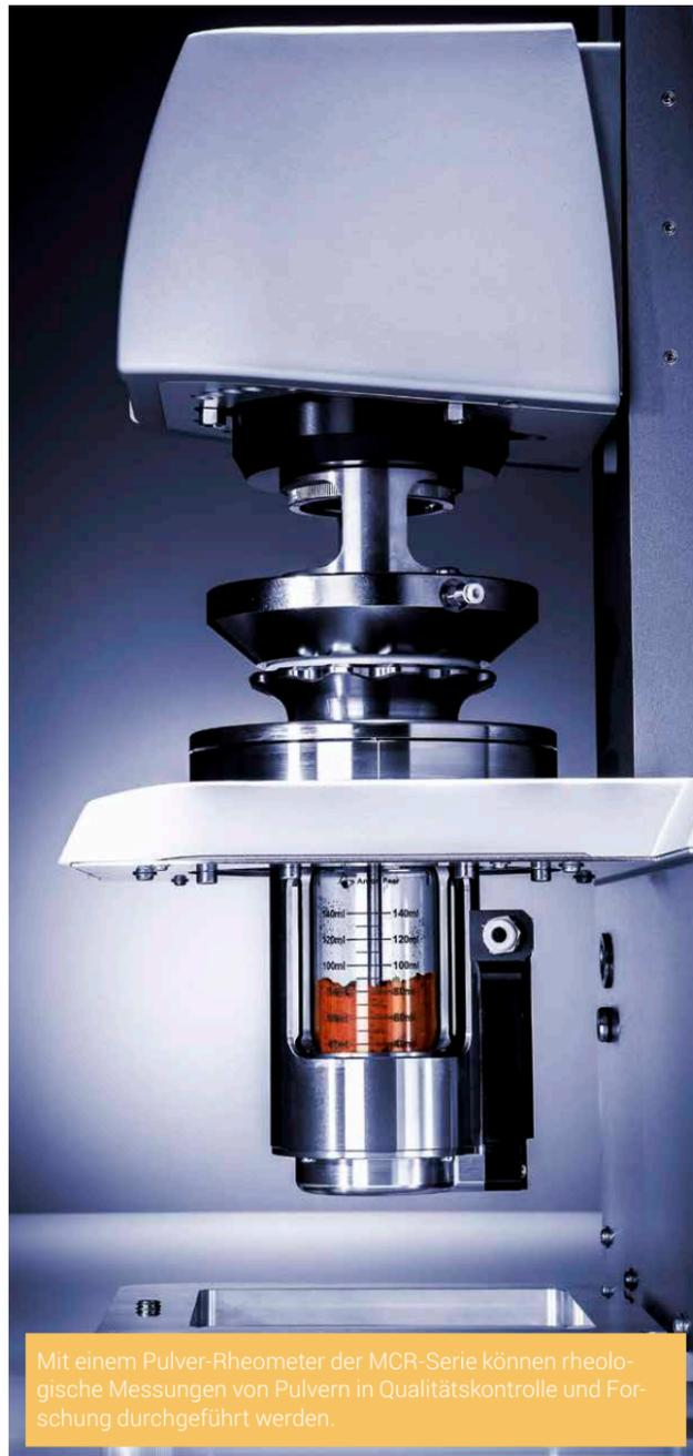
Mit einem Pulver-Rheometer der MCR-Serie können rheologische Messungen von Pulvern in Qualitätskontrolle und Forschung durchgeführt werden.
