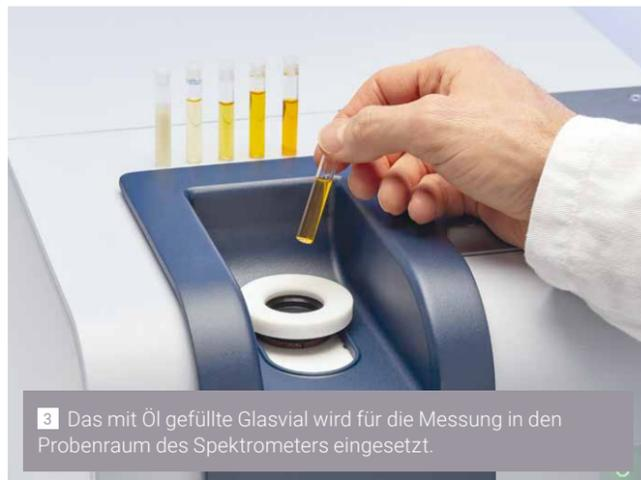
3 Das mit Öl gefüllte Glasvial wird für die Messung in den Probenraum des Spektrometers eingesetzt.
