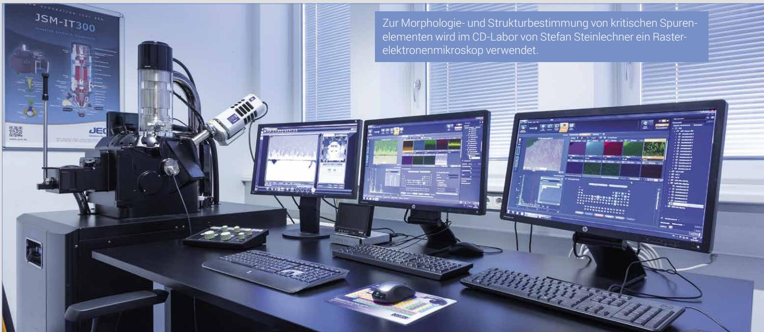
Zur Morphologie- und Strukturbestimmung von kritischen Spurenelementen wird im CD-Labor von Stefan Steinlechner ein Rasterelektronenmikroskop verwendet.
