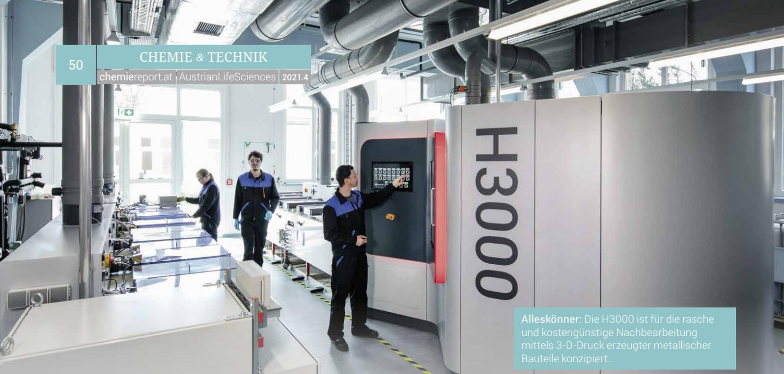
Alleskönner: Die H3000 ist für die rasche und kostengünstige Nachbearbeitung mittels 3-D-Druck erzeugter metallischer Bauteile konzipiert.
