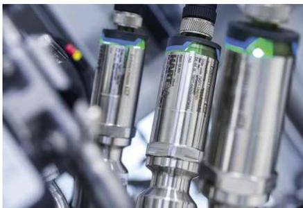
Selbstkalibrierende Temperatursensoren spielen bei Sterilization-in-Place (SIP) und Autoklavierung in der Pharmaindustrie eine wichtige Rolle. Das größte Maß an Sicherheit lässt sich erreichen, wenn man eine geeignete Vorgangsweise der Datenintegration wählt.
