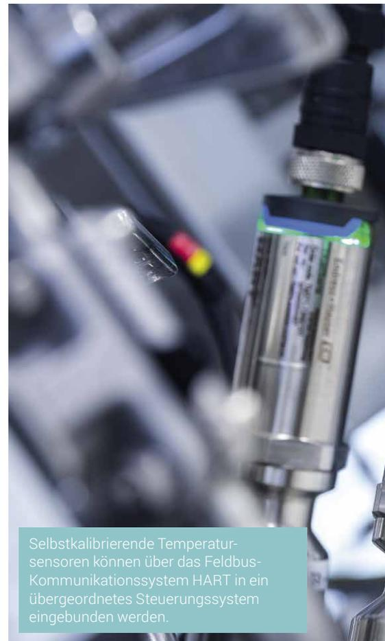
Selbstkalibrierende Temperatursensoren können über das Feldbus-Kommunikationssystem HART in ein übergeordnetes Steuerungssystem eingebunden werden.
