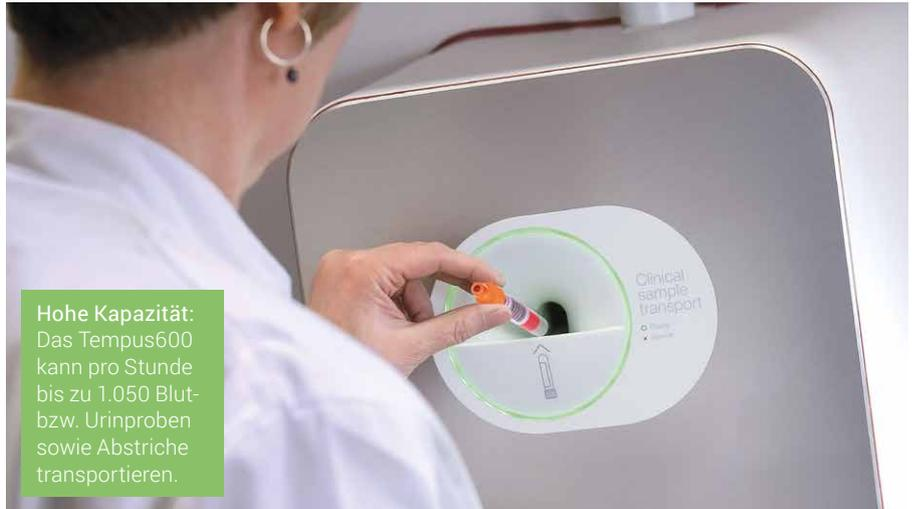
Hohe Kapazität: Das Tempus600 kann pro Stunde bis zu 1.050 Blut- bzw. Urinproben sowie Abstriche transportieren.
