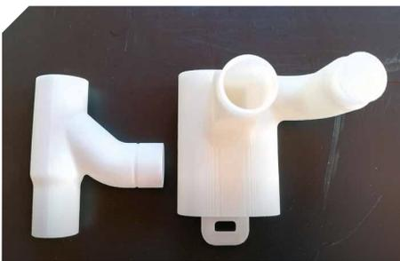
Die Firma Nemeton hat spezielle Komponenten (im Bild ein Verteiler) eines Beatmungsgeräts entwickelt und gedruckt.
