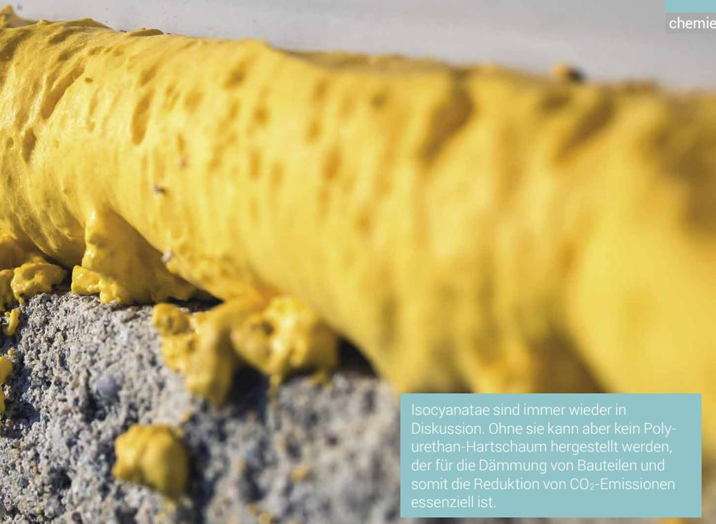
Isocyanate sind immer wieder in Diskussion. Ohne sie kann aber kein Polyurethan-Hartschaum hergestellt werden, der für die Dämmung von Bauteilen und somit die Reduktion von CO<sub>2</sub>-Emissionen essenziell ist.
