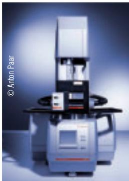
Anton Paar stellt ein neues Rheometer vor: Das MCR 702 mit TwinDrive-Technologie verfügt über eine Drehmomentgenauigkeit von 1 nNm sowie Features wie das Piezo-Flansch IsoLign. Damit sind laut Hersteller erstmals Messungen im Nanometerbereich möglich. Die TwinDrive-Technologie von Anton Paar verbindet zwei synchrone, elektronisch kommutierte Motoren in einem modularen Set-up. Der obere EC-Motor
