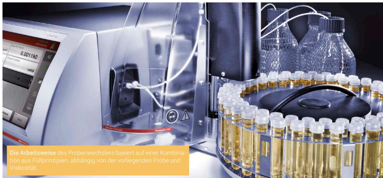
Die Arbeitsweise des Probenwechslers basiert auf einer Kombination aus Füllprinzipien, abhängig von der vorliegenden Probe und Viskosität.
