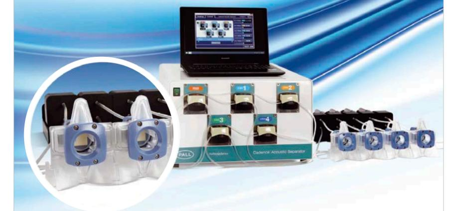
Der Cadence™ Acoustic Separator nutzt dreidimensionale Schallwellen, um eine effiziente und kontinuierliche Entfernung von Zellen durchzuführen.
