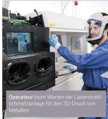
Operateur beim Warten der Laserstrahlschmelzanlage für den 3D-Druck von Metallen
