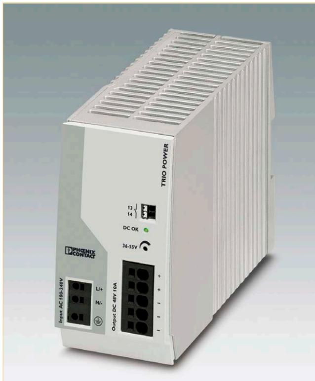
Die neuen Spannungsvarianten der Stromversorgungsfamilie Trio Power von Phoenix Contact stellen auch unter widrigen Umgebungsbedingungen eine zuverlässige Versorgung der Verbraucher sicher. Zu den neuen Stromversorgungen gehören je zwei 12- und 48-Volt-Geräte mit 5 und 10 Ampere Ausgangsstrom, die sich insbesondere für Anwendungen in Telekommunikation sowie Maschinenbau eignen. Sie sind wie ihre Vorgänger elektrisch und mechanisch sehr robust.
