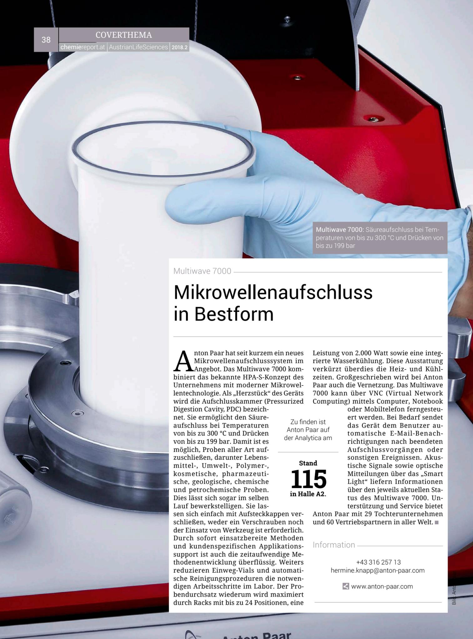
Multiwave 7000: Säureaufschluss bei Temperaturen von bis zu 300 °C und Drücken von bis zu 199 bar
