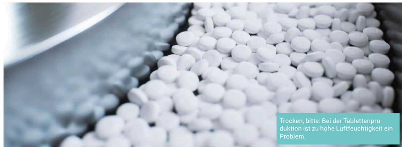
Trocken, bitte: Bei der Tablettenproduktion ist zu hohe Luftfeuchtigkeit ein Problem.
