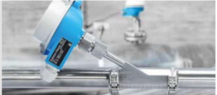
Medien, bei Abrasion, Molchung oder kleinen Rohrdurchmessern bietet iTHERM SurfaceLine TM611 die gleiche Genauigkeit und Ansprechzeit wie invasive Temperaturmessungen. Ein speziell entwickeltes thermisches Koppellement gewährleistet die ideale Wärmeleitfähigkeit zum Sensor und reduziert Umgebungseinflüsse. Damit übertrifft die Messleistung des
