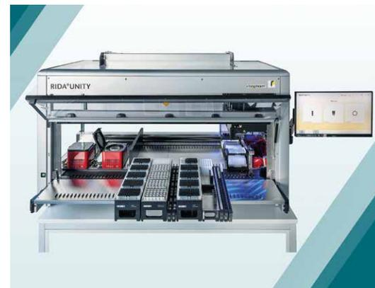
Das „Rida Unity“-System von R-Biopharm für die vollautomatische Real-Time-PCR
