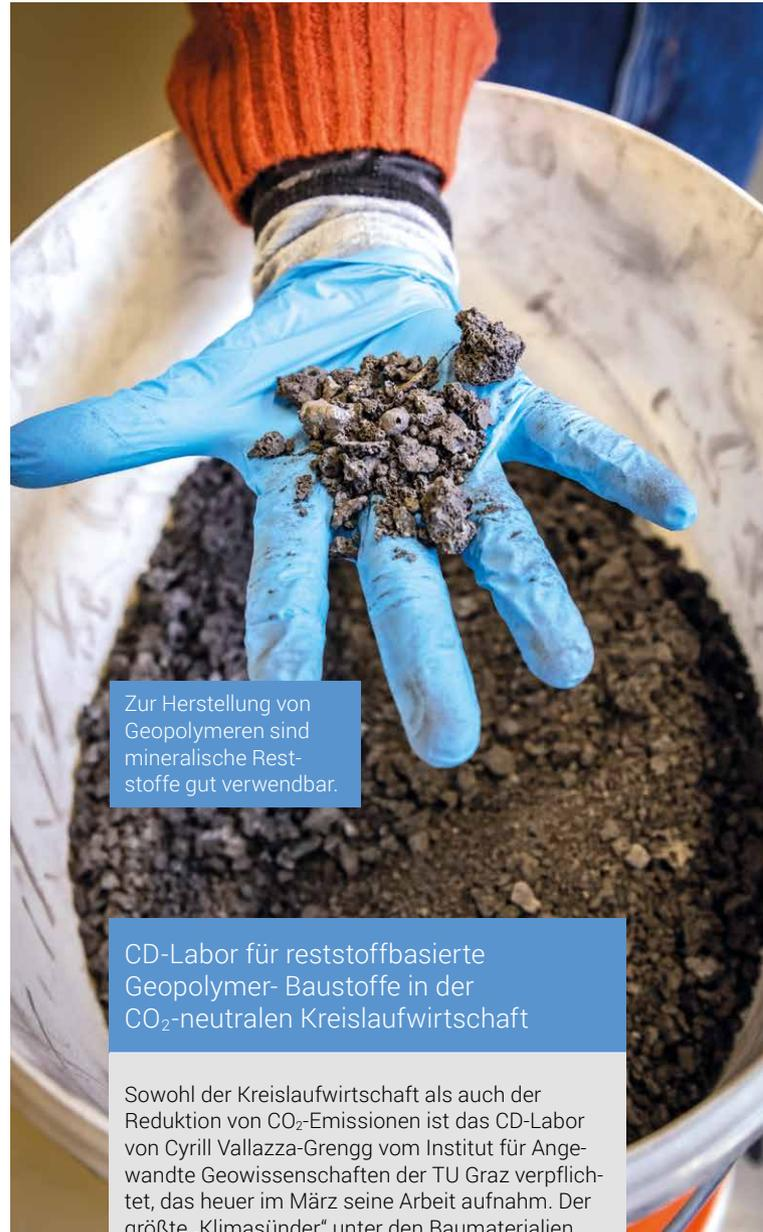
Zur Herstellung von Geopolymeren sind mineralische Reststoffe gut verwendbar.
