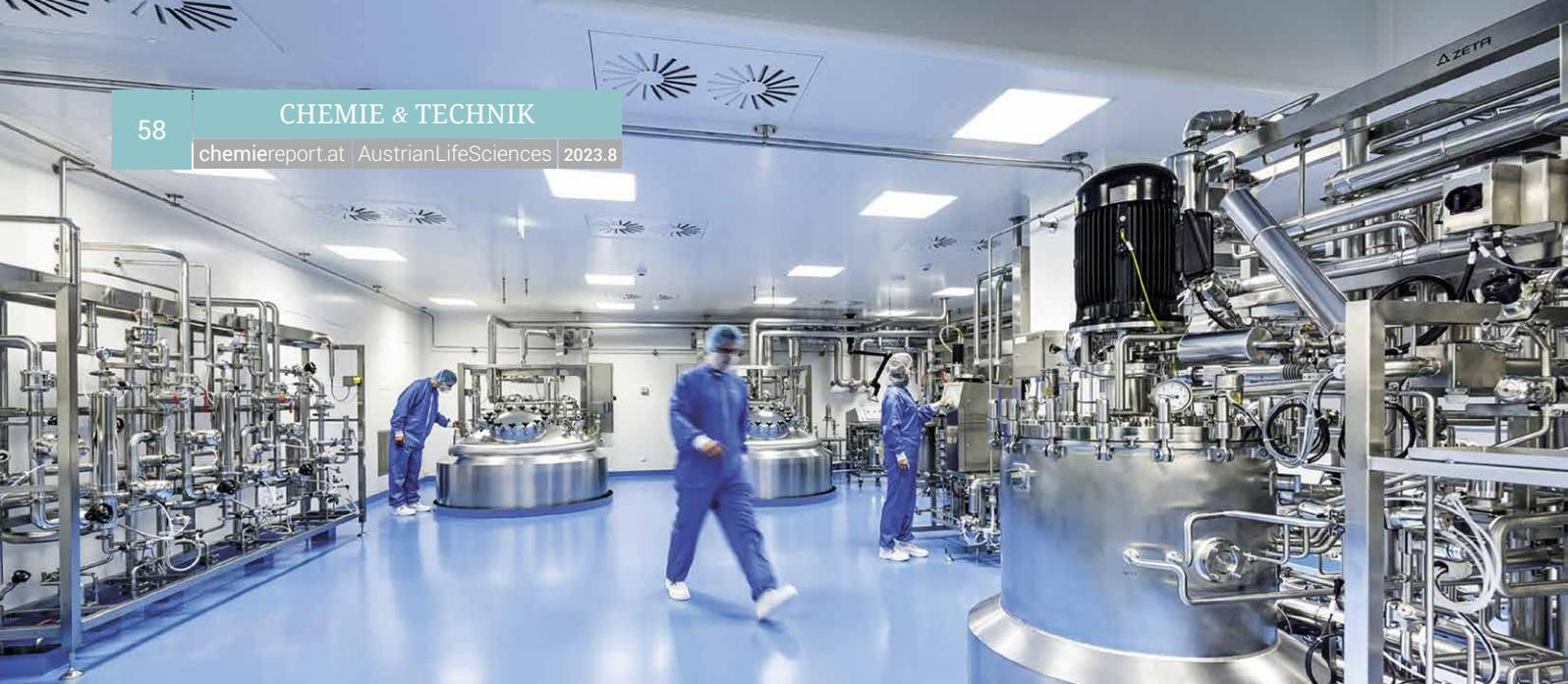
Herzstück des Neubaus ist die Produktionsanlage, die für die biotechnologische Herstellung von aktiven pharmazeutischen Wirkstoffen in E. coli ausgelegt ist.
