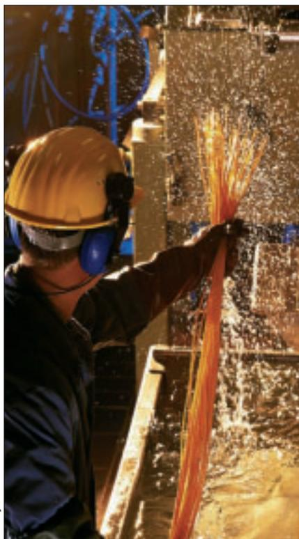
Makrolon-Produktion: Die Stränge werden anschließend zu Granulat.
