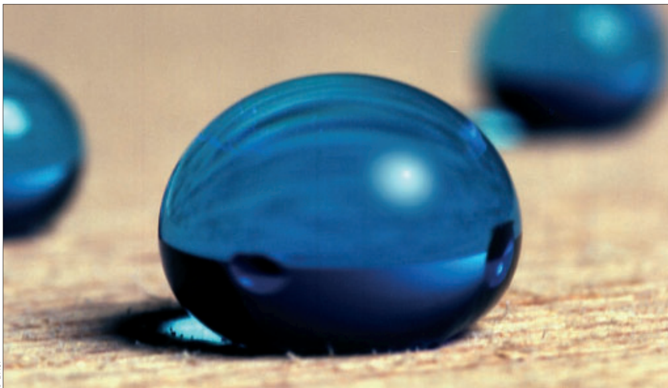
Geheimnisvolle blaue Perlen? Nein, die Wassertropfen prallen auf der imprägnierten Holzoberfläche ab, nachdem diese durch eine nanopartikuläre Oberflächenbeschichtung zur superhydrophoben Oberfläche wurde.
