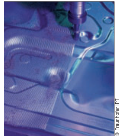
Automatische Laserbeschichtung und Hochgeschwindigkeitsfräsen.
