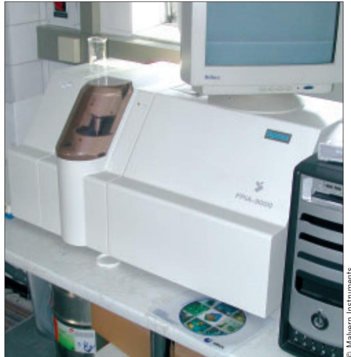
Sysmex FPIA-3000: Ermöglicht Feinkornbestimmung im Beton.
