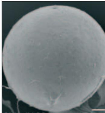
Elektronenmikroskopische Aufnahme einer NovaCaps-Kapsel.
