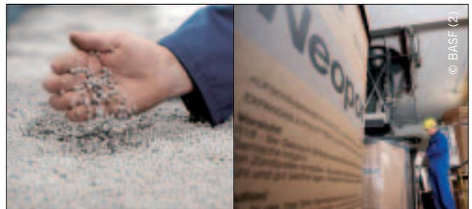
Neopor erzielt bei geringerem Materialeinsatz die gleiche Dämmleistung wie Styropor.
