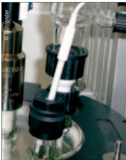
BOLA-Thermofühler PT 100: Resistent dank PTFE-Überzug.
