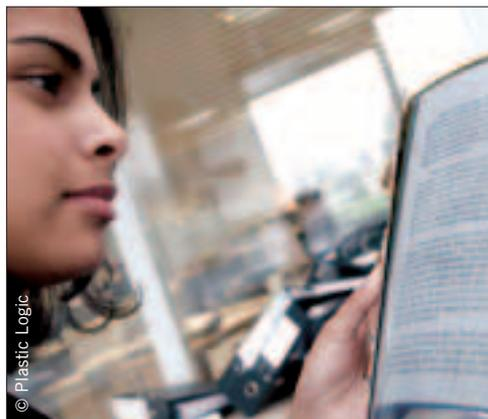
Die Integration des von E Ink entwickelten Frontfolienmaterials ermöglicht die papierähnliche Verwendung der Displays.
