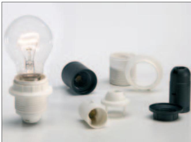
Verbessertes Spritzgießen: Dank Pocan XF konnten die Wanddicken von Lampenkomponenten deutlich reduziert und die Schmelztemperatur bei der Produktion um 15 °C gesenkt werden. Die Zykluszeiten verringerten sich dadurch um 12-15 %.
