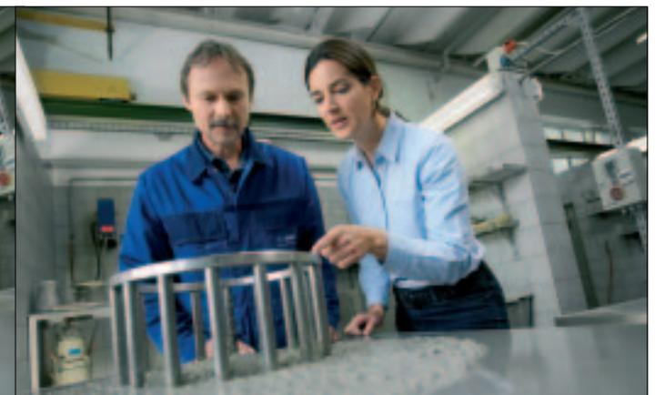
Im Betonlabor wird selbstverdichtender Beton getestet. Fließmittel, Stabilisierer und Luftporenbildner helfen beim Entlüften
