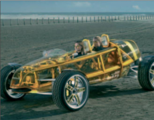
In die Zukunft weist das Concept Car eXaxis: Mit leichten Karosserieteilen aus transparentem Makrolon, mit Kopfstützen- und Armlehnenpolstern aus dem PUR-Gel Technogel, Kabelummantelungen aus dem abrieb- und medienbeständigen TPU Desmopan sowie mit Softfeellacken im Innenraum auf Basis wässriger Lackrohstoffe der Reihen Bayhydrol und Bayhydur. Der eXaxis verbraucht auf 100 km 6,3 l Bioethanol, was einem CO<sub>2</sub>-Ausstoß von nur 20 g/km entspricht.
