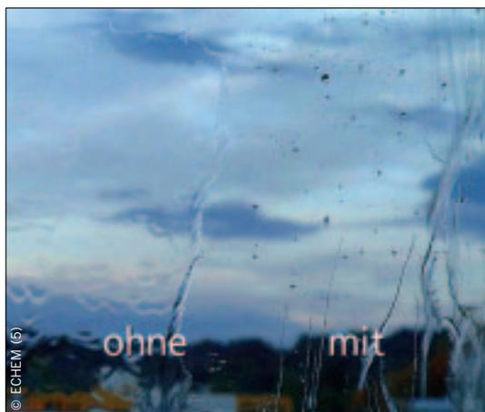
Wassertropfen perlen an der hydrophobierten Oberfläche ab.
