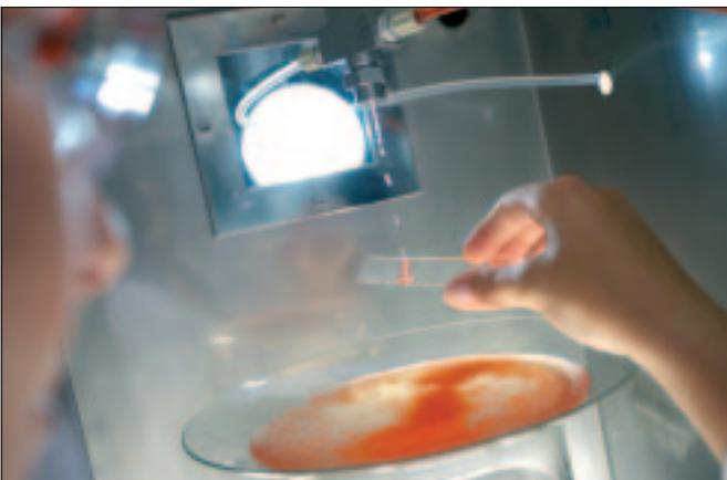
Die Mikroverkapselung dient der kontrollierten, verzögerten Freisetzung eines Wirkstoffs. Nachdem die aus Katalysatoren und anderen Zusatzstoffen bestehende Kernlösung durch Abfiltrieren gereinigt wurde, gelangt sie unter Druck in die Innendüse. Gleichzeitig kommt das Kapselwandmaterial in die Außendüse. Kern- und Wandmaterial verbinden sich in der Mikroverkapselungsmaschine. Durch Vibration reißt der Flüssigkeitsstrahl ab und es entstehen Tropfen.
