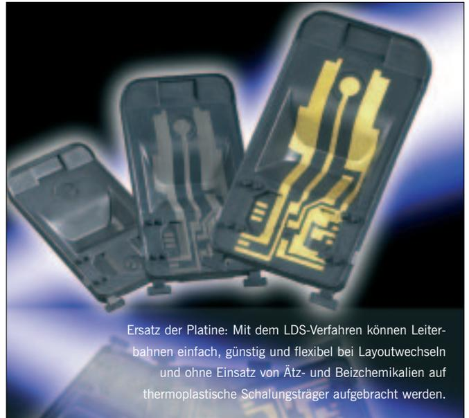
Ersatz der Platine: Mit dem LDS-Verfahren können Leiterbahnen einfach, günstig und flexibel bei Layoutwechseln und ohne Einsatz von Ätz- und Beizchemikalien auf thermoplastische Schalungsträger aufgebracht werden.
