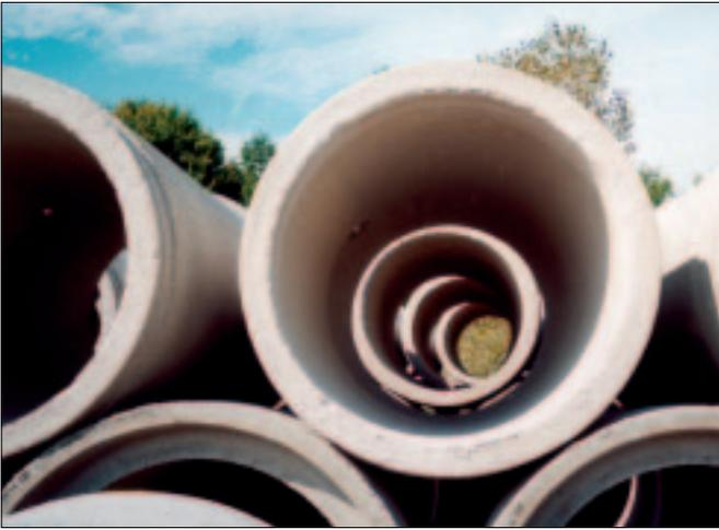
Bei der Herstellung von Betonfertigteilen sorgt Glenium Ace dafür, dass Beton eine höhere Frühfestigkeit entwickeln kann. Der Beton verdichtet von selbst und muss nicht gerüttelt werden, um zu entlüften.
