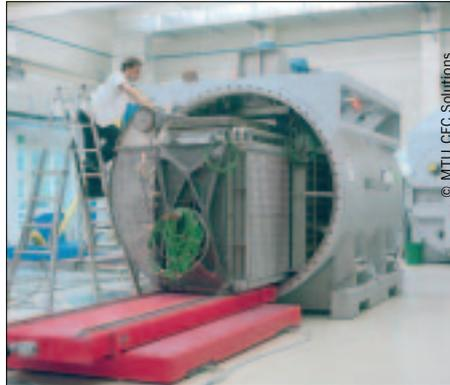
Bei der Verbrennung von Gas in Motoren entstehen 35 % Strom und 50 % Wärme. Profactor hat eine Schmelzkarbonat-Brennstoffzelle getestet, bei der das Verhältnis umgekehrt ist. Der Biowasserstoff wird dabei in einer elektrochemischen Reaktion in der Brennstoffzelle in Strom und Wärme umgewandelt.
