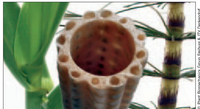
Der Technische Pflanzenhalm (Mitte) ist ein bionisches Faserverbundmaterial mit Gradientenstruktur, das hohe Steifigkeit mit sehr guter Schwingungsdämpfung und einem gutmütigen Bruchverhalten verbindet. Das Pfahlrohr (*Arundo donax*, links) und verschiedene Schachtelhalmarten (*Equisetum sp.*, rechts) waren zwei der Vorbilder bei seiner Entwicklung.
