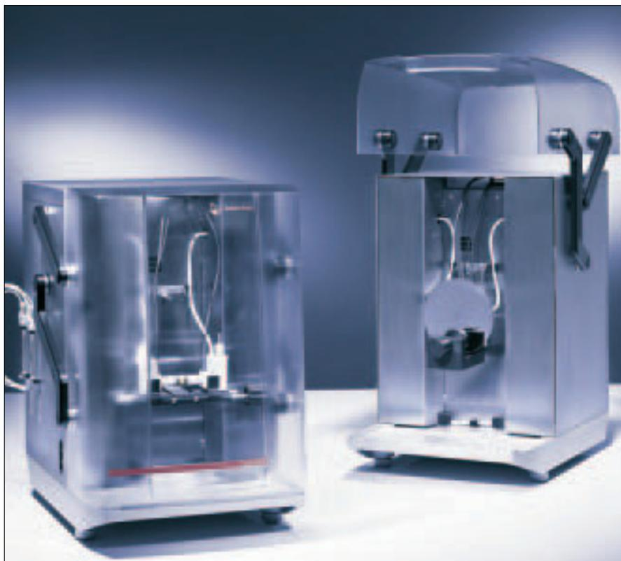
Abb. 2: SurPASS mit integrierter Titrationseinheit, Fasermesszelle (links) und Klammernmesszelle mit Siliziumwafer als Probe (rechts).
