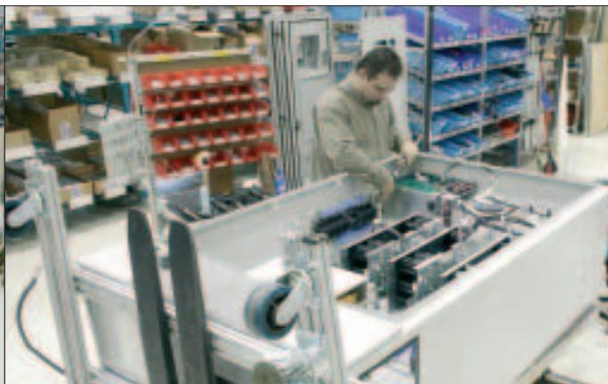
US-Produktion von Danfoss in Loves Park: Auf 11.500 m<sub>2</sub> werden hier rund 60.000 Geräte p.a. produziert. Bis 2009 wird die Kapazität aufgrund deutlicher Umsatz- ausweitungen kurzerhand verdoppelt. Die Hauptkomponenten werden von Danfoss Silicon Power in Schleswig bezogen und hier in die Umrichter integriert.
