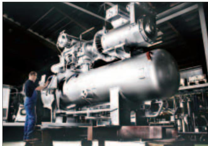
Luftkompressoren verursachen in Brauereien und Abfüllanlagen hohe Kosten. Da Luftdruck rund zehn Mal so teuer wie Strom ist und die Anlagen typischerweise nur zu 70–80 % ausgelastet sind, eignen sich variable Antriebe hier besonders. Ein Return-on-Investment wird hier in weniger als zwei Jahren erzielt.
