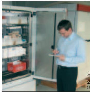
Die Klimaschränke erfüllen die Anforderungen gemäß ICH-Q1A. Das platzsparende Gehäuse mit nur noch einer Tür spart bei gleichem Nutzraum Stellfläche im Labor.
