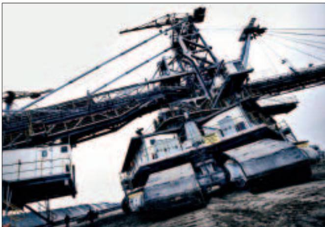
Die KONIN Lignite Mine Company in der Wielkopolska-Region in Westpolen produziert jährlich 15 Mio. t Kohle aus vier offenen, 40–250 m tiefen Gruben. Die Kohle wird dabei über ein Förderband zu zwei Kraftwerken transportiert: Konin (500 MW) und Patnow (1.200 MW). Im Zuge der Modernisierung des 1.150 t schweren Schaufelradbaggers wurde auch das kilometerlange Förderband mit neuen Danfoss-Antrieben versehen: Binnen elf Monaten sparten diese mehr als 150.000 Euro an Stromkosten ein.
