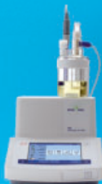
Wasserbestimmung durch Karl Fischer Titration
