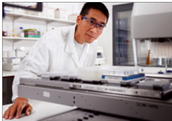
Beim Beladen eines Screening-Roboters. Der Roboter erkennt, ob der Transport eines neuen Gens in die Reispflanze gelungen ist. Dazu werden die genetischen Informationen aus den Blättern gewonnen.
