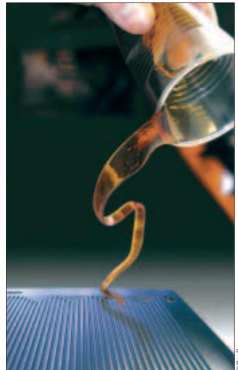
Der latente Säurekatalysator CSR10 kann die Lagerfähigkeit von Prepolymer-Vormischungen auf drei Monate erhöhen.
