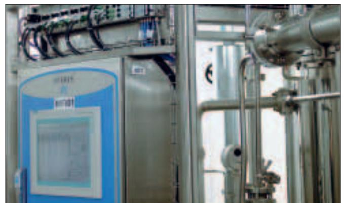
Der Hygienetechnik-Anbieter Steris Finn-Aqua integriert in seine Multieffekt-Wasserdestillationsanlagen zur Erzeugung von Reinstwasser die CPX/MPA-Ventilinsel.
