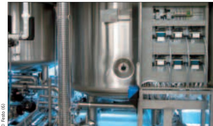
Automatisierungs-Komplettpakete von Festo: Einbaufertige Schaltschränke mit Ventilinseln als Teil eines durchgängigen Automatisierungskonzepts.
