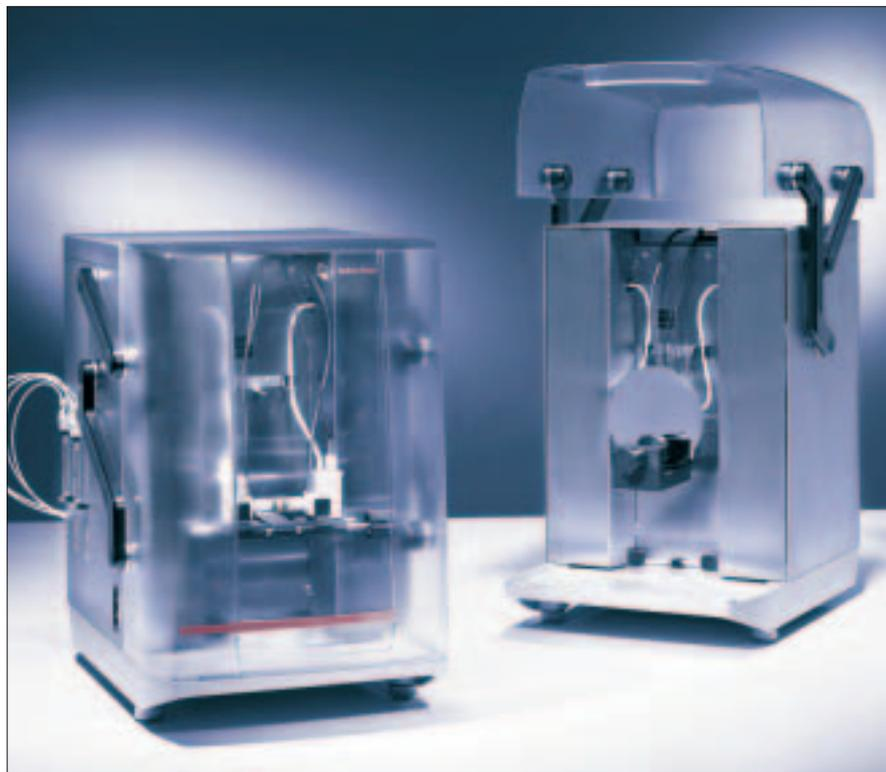
Das Messsystem „Surpass“ von Anton Paar mit integrierter Titrationseinheit, Fasermesszelle (links) und Klammernesselle mit Siliziumwafer als Probe (rechts).
