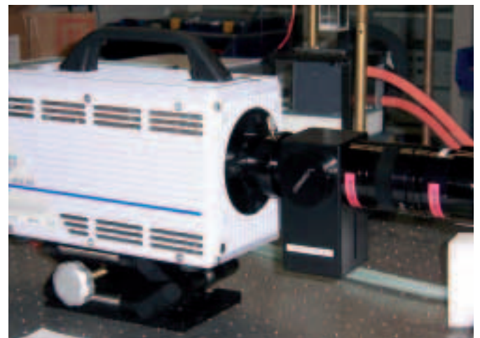
Mit Hochgeschwindigkeitskameras kann die Erosion durch Kavitation oder Tropfen beobachtet werden.
