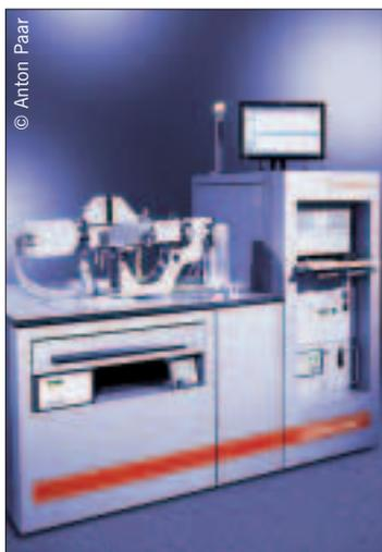
Die Röntgenkleinwinkelstreuung (SAXS) dient der Aufklärung der Zusammenhänge zwischen der Nanostruktur eines Materials und seinen physikalischen, chemischen und biologischen Eigenschaften. SAXS erlaubt die Untersuchung von Strukturen im Größenbereich von einem bis 100 Nanometern in verschiedensten Materialien, von Flüssigkeiten (Kolloiden, Proteinen und Tensiden) bis zu Feststoffen (Polymeren, Fasern und Nanokompositen). Für
