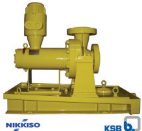
Nikkiso Spaltrohrmotorpumpen werden häufig für aggressive, brennbare explosionsgefährliche oder giftige Flüssigkeiten eingesetzt. Die Pumpen sind geeignet zum Einsatz in Vakuumsystemen, die Gehäuse sind so ausgelegt, dass Systemdrücke bis 40 bar mit der Standardausführung möglich sind. Alle Modelle und Motoren sind gemäß Richtlinie 94/9/EG (ATEX 95) für den Explosionsschutz zertifiziert.
