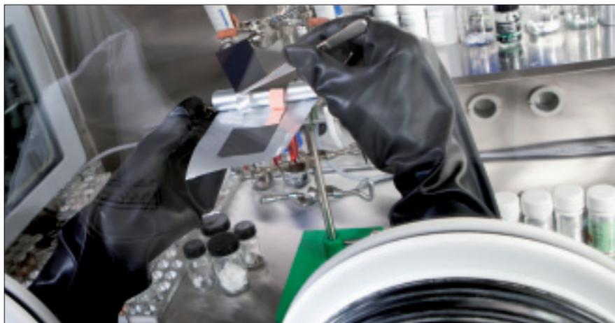
Zusammenbau einer Lithium-Ionen-Testbatterie, mit der verschiedene Kathodenmaterialien untersucht werden
