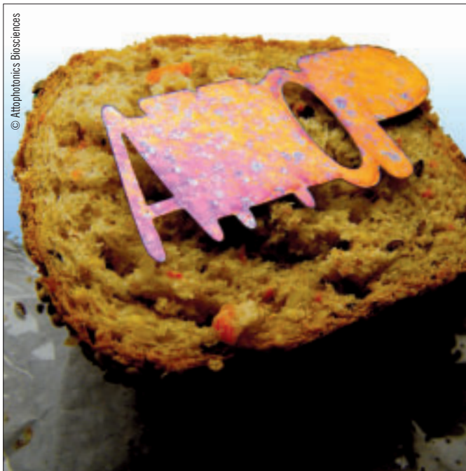
In einem COIN-Projekt wurden unter der Koordination der Firma Attophotonics Biosciences sensorische Pigmente entwickelt, die bei der Einwirkung von Feuchtigkeit einen Farbumschlag zeigen.
