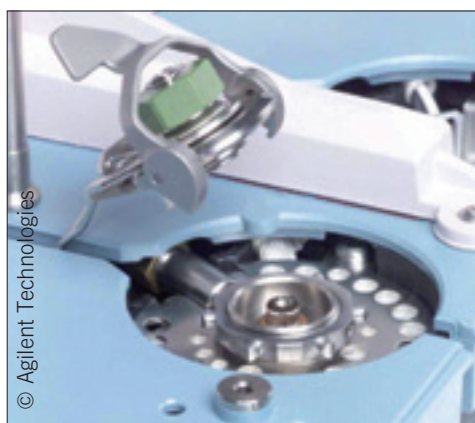
Abb. 4: „Flip Top Inlet Sealing“-Schnellverschluss zum raschen, werkzeuglosen Liner-Austausch.
