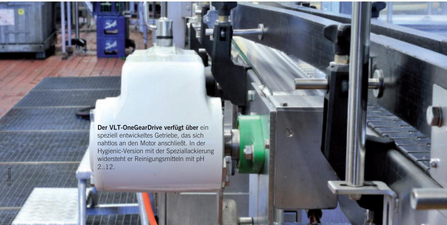
Der VLT-OneGearDrive verfügt über ein speziell entwickeltes Getriebe, das sich nahtlos an den Motor anschließt. In der Hygienic-Version mit der Speziallackierung widersteht er Reinigungsmitteln mit pH 2..12.
