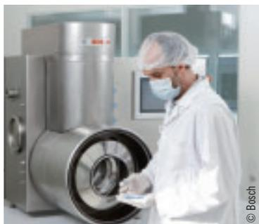
Hüttlin und Manesty, die zur Bosch Packaging Technology gehören, haben die Laboranlagen Solidlab 1 und 2 für die Herstellung von Tabletten und Pellets entwickelt. Durch die Nutzung einer gemeinsamen Basiseinheit lassen sich die unterschiedlichen Prozessmodule Pul-
