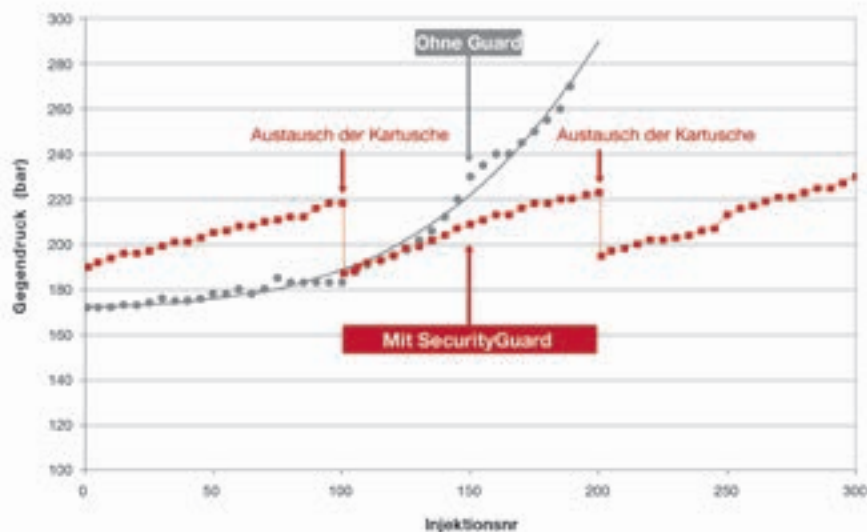
Bild 3: Verlängerung der Standzeit einer Core-Shell-UHPLC-Säule („Kinetex“ 2,6 \mu\text{m} C18 50 x 4,6 mm) durch eine Vorsäule („Security Guard Ultra“). Nach Austausch der Einwegkartusche ist der Druckanstieg reversibel.
