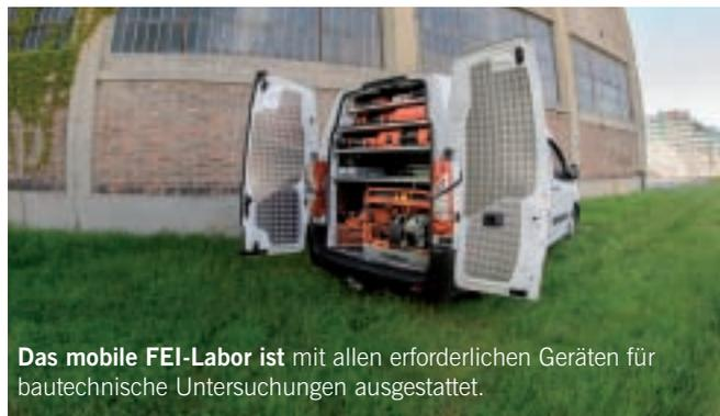
Das mobile FEI-Labor ist mit allen erforderlichen Geräten für bautechnische Untersuchungen ausgestattet.
