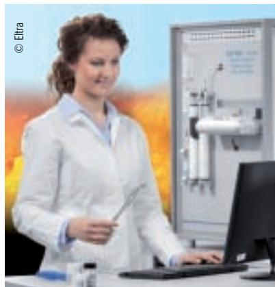
Der CHS-580-Analysator von ELTRA eignet sich besonders für die Bestimmung von Kohlenstoff, Schwefel und Wasserstoff in organischen Proben wie Brennstoffen, Ölen, Chemikalien, Böden und Zement. Das Gerät verfügt über einen bis 1.550 °C beheizbaren keramischen Ofen. Es ermöglicht,
