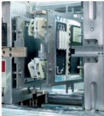
**BASF hat eine** eigene Fertigungszelle zum Umformen von Endlosfaser-Laminat aufgebaut.
