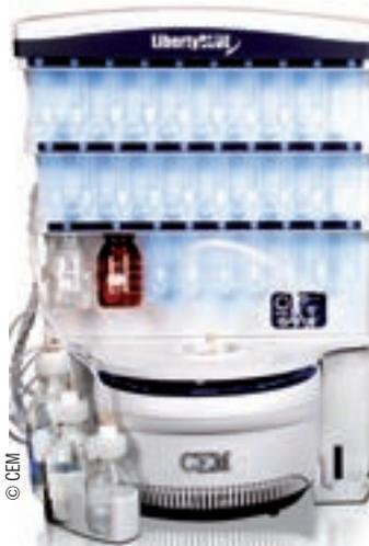
Dies führt laut CEM auch zusätzlich zu einer Einsparung von 90 Prozent bei Lösemitteln. Die HE-SPPS ermöglicht die Synthese eines Peptids in weniger als einer Stunde.
