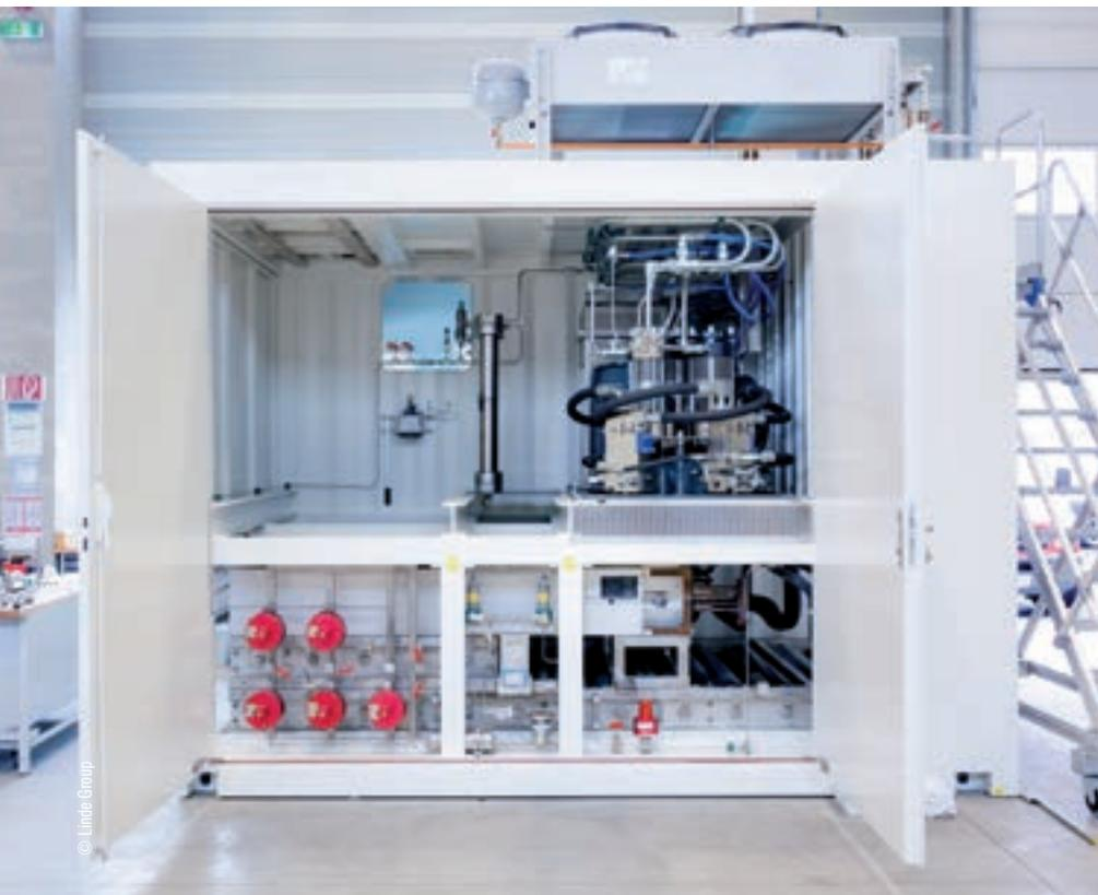
Ionische Verdichter des Typs IC 90 sind das Herzstück einer Wasserstofftankstelle.
