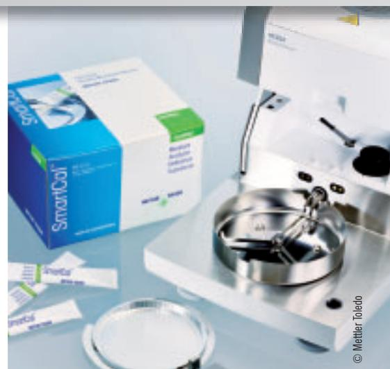
Mettler Toledo hat den Referenzstandard „SmartCal“ für die Leistungsüberwachung von Feuchtigkeits-Analysatoren entwickelt.
