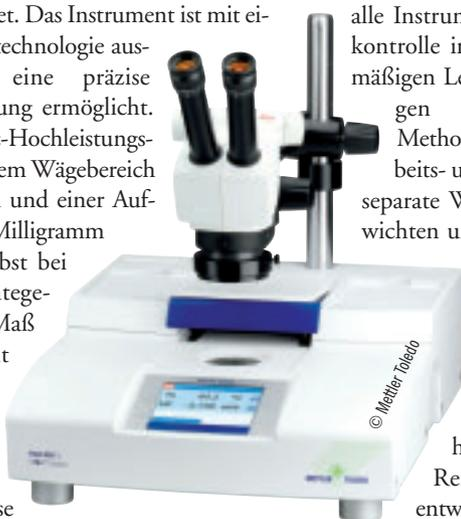
Mit dem Gerät „Flash DSC 1“ lassen sich Kristallisationsprozesse beobachten, wie sie beim Spritzgießen auftreten.
