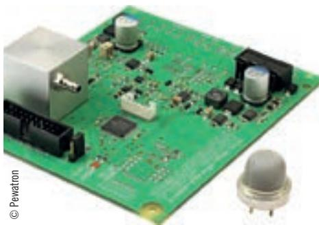
Stromausgang (0–20 mA), analoger, linearisierter Spannungsausgang (0–10 V) oder digitaler Ausgang über das Kommunikationsprotokoll RS485. Da die Gesamtstromaufnahme gering ist, eignet sich
