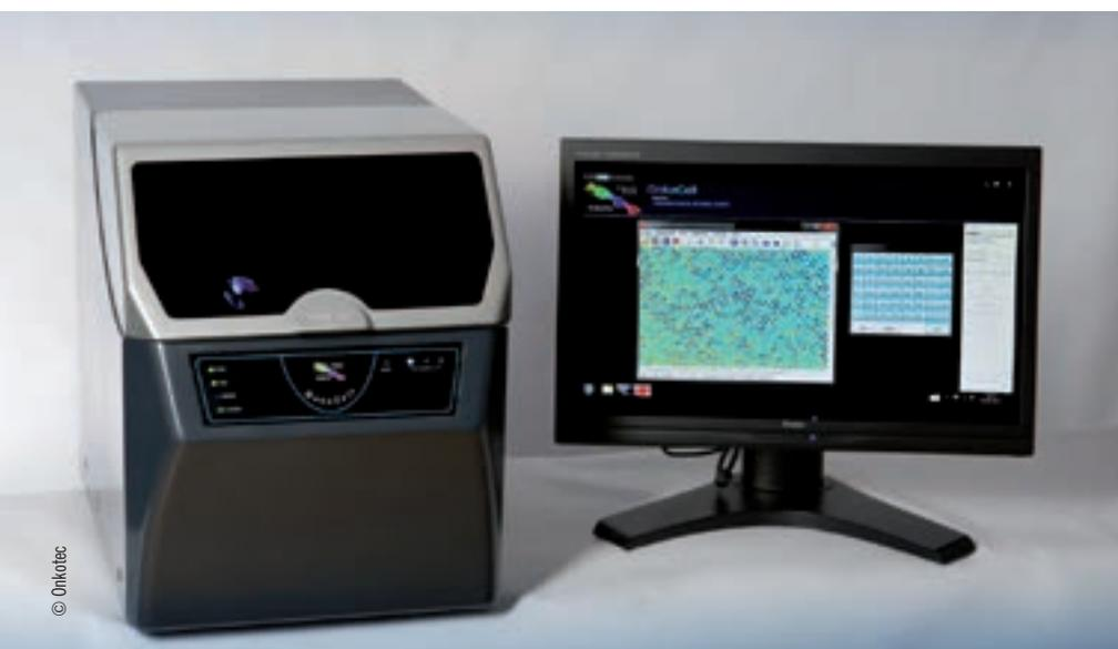
Mit dem Gerät „OnkoCell“ lassen sich Fluoreszenzbilder des Urinsediments erstellen, in denen Krebszellen gezählt und charakterisiert werden können.
