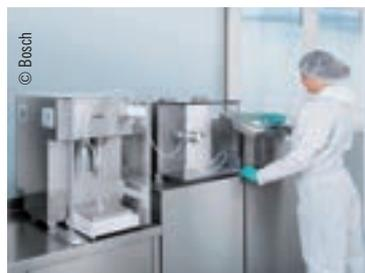
Sie besteht zurzeit aus vier Modulen, der Benutzerschnittstelle (Human Machine Interface, HMI), dem Füllmodul mit Peristaltikpumpe, dem Waagemodul und der Nadelbewegung. Die FHM-Serie vereinfacht laut Bosch das „Design of Experiments“ (DoE, statistische Versuchsplanung) durch umfangreiche Dokumentation aller Versuchsparameter und ermöglicht ein einfaches „Scale-up“ auf Produktionssysteme.
