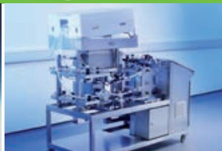
Vollautomatisierte Allegro™ Single-Use-Tangentialflussfiltrationssysteme mit 0,5 m<sup>2</sup> - 10 m<sup>2</sup> Membranfläche
