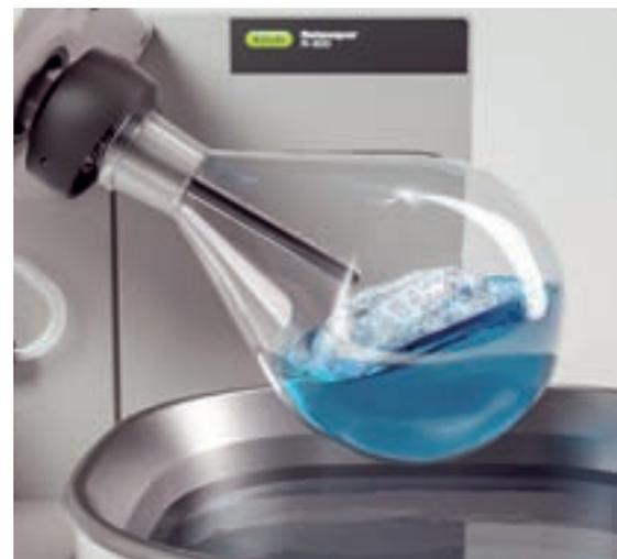
Für das automatische Destillieren von schäumenden Proben hat Büchi eigens einen optischen Schaumsensor entwickelt.
