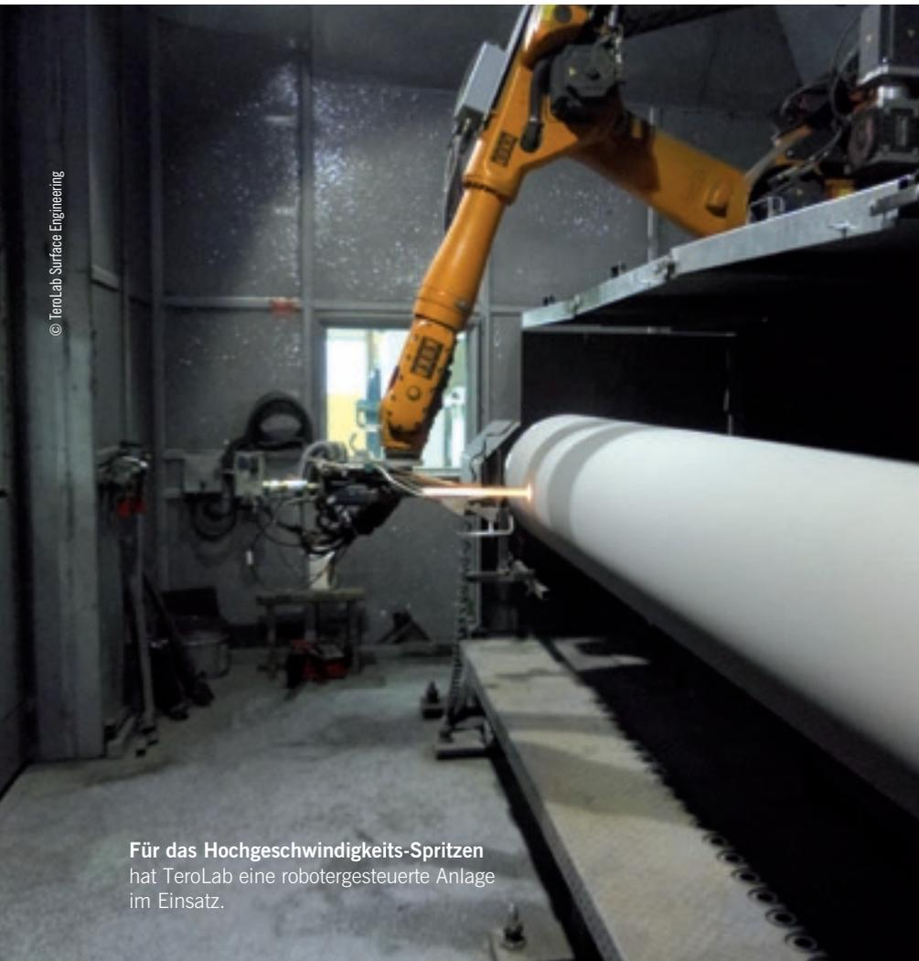
Für das Hochgeschwindigkeits-Spritzen hat TeroLab eine robotergesteuerte Anlage im Einsatz.
