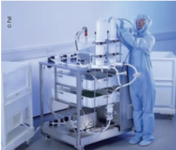
Pall Life Sciences präsentiert mit dem Allegro-MVP-Single-Use-System eine Plattform zur flexiblen Automatisierung verschiedener Arbeitsschritte im Bioprocessing. Mögliche Anwendungen finden sich in der Sterilfiltration, Bioburdenkontrolle und Tiefenfiltration, der Virusfiltration und Virusinaktivierung, der Membranchromatographie, der Medien- und Puffervorbereitung
